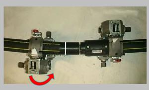
• Ramener le deuxième tube horizontalement dans l'axe du 1<sup>er</sup>.
