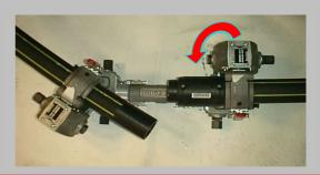
Ne jamais ramener simultanément les deux tubes ensemble dans le plan horizontal sous peine d'un glissement intempestif du positionneur qui peut être dangereux pour l'opérateur.
